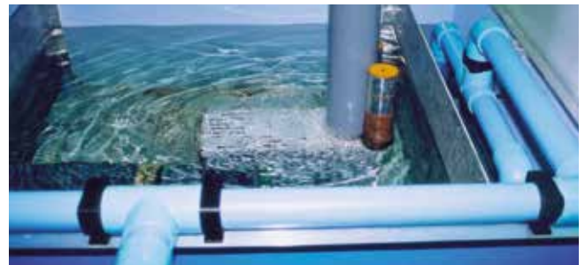
Prova di evacuazione su un pozzetto pluviale.
