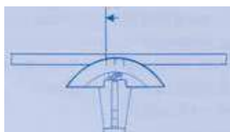
Fase 2 - Porre il tubo nella pinza curvatubi.
