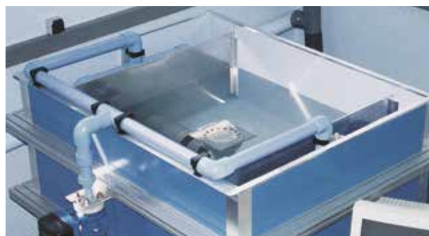
Prova di evacuazione su un chiusino sifonato.
