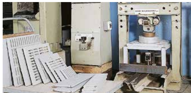
Prova di rottura su una griglia pesante.
