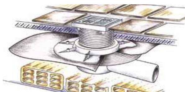
esempio di installazione con membrana impermeabilizzante
